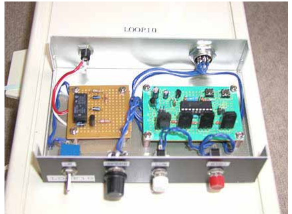
写真6. コントローラ内部
